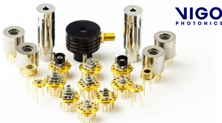
Rys. 10. Detektory podczerwieni opracowane przez firmę VIGO Photonics S.A.
