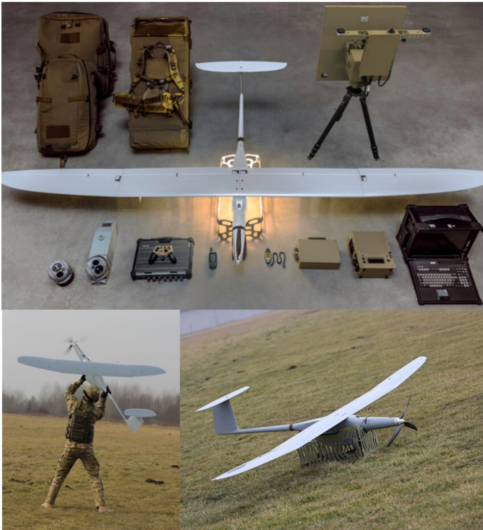
Rys. 18.4. Bezałogowy statek powietrzny FlyEye (produkcji Grupy WB) wyposażony w heterogeniczny zasobnik wraz z wyposażeniem taktycznym
