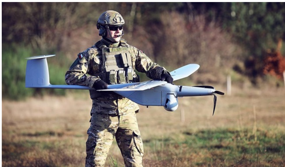
Rys. 18.3. Zasobnik heterogenicznej platformy UAV FlyEye (produkcji Grupy WB) z zabudowanym modułem radiowym oraz kamerą światła dziennego i kamerą termowizyjną
